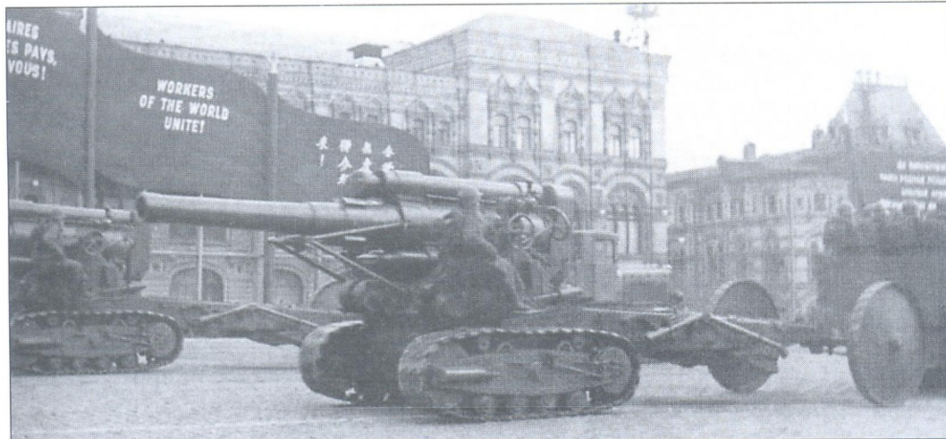
203-мм гаубицы Б-4 на параде идут по Красной площади. Хорошо виден гусеничный ход гаубицы
