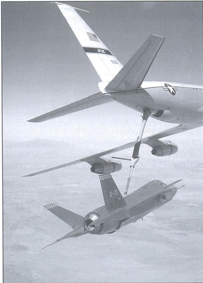
F-35A ВВС США заправляется в воздухе с помощью жесткой штанги
