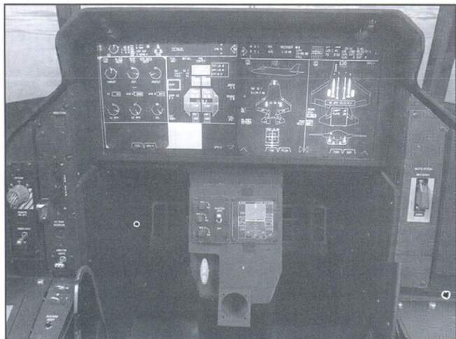
В кабине F-35 установлен один большой экран дисплея
