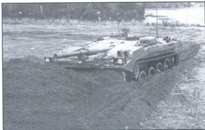
Strv-103 отрывает окоп с помощью бульдозерного отвала
