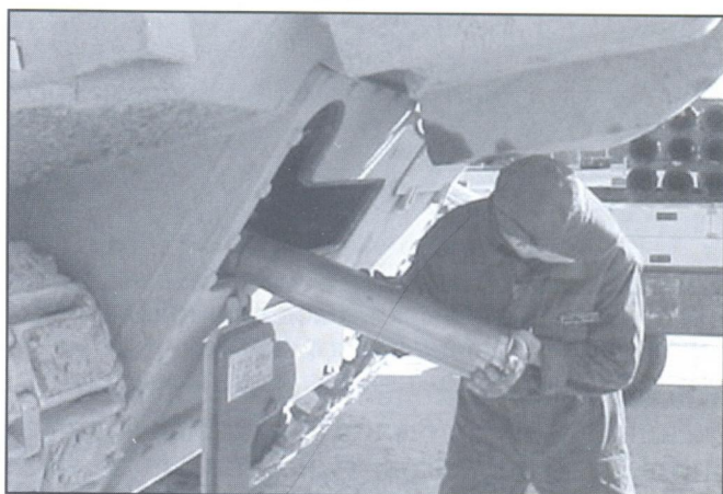
Пополнение боезапаса в автомате заряжания
