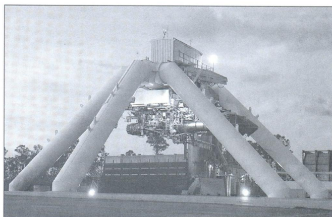
Стенд для испытания двигателя для F-35
