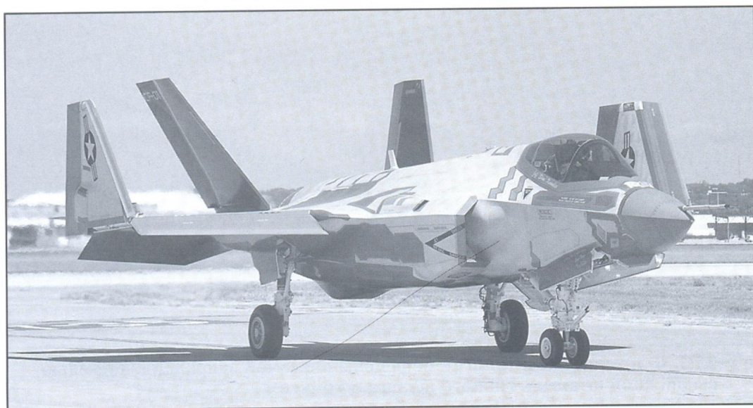
Отличительной чертой палубного истребителя F-35C являются складывающиеся крылья увеличенной площади.
