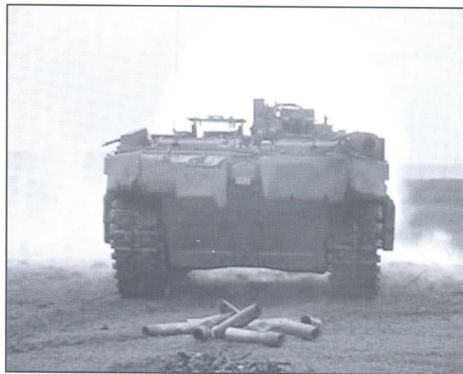
При стрельбе пустые гильзы выбрасываются за корму танка
