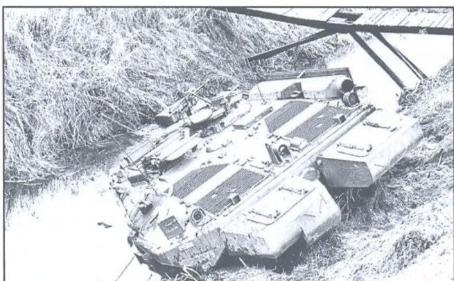
Утонуть в канаве случается даже танкам... Низкорасположенная пушка танка часто утыкалась в грунт
