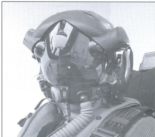
Суперсовременный шлем пилота F-35, на защитное стекло которого может выводиться информация о полете и боевой задаче
