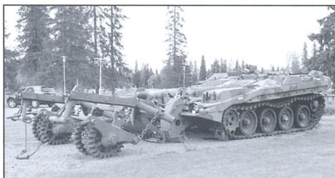
Для преодоления минных полей Strv-103 мог оснащаться катковым минным тралом
